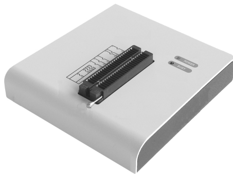
Figuur 11.25 : Een programmer voor programmeerbare bouwstenen. In de ZIFF-socket wordt de PROM, PAL of microcontroller geplaatst. Met een programmeerprogramma wordt het hex- of het JEDEC-bestand met de fuse-map geopend en wordt de component geprogrammeerd.
