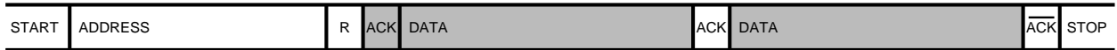
Figuur 21.10 : Het protocol voor het ontvangen van gegevens door de master naar een slave. Na de startconditie START verstuurt de master het slave-adres ADDRESS, het schrijfbits R. De slave reageert met een ACK en stuurt het eerste databyte. De master bevestigt dat steeds met een ACK. Als de master stopt stuurt het geen ACK maar een NACK ( \overline{\text{ACK}} ). Zo weet de slave dat er geen gegevens meer verstuurd hoeven te worden. De master beëindigt de communicatie met de STOP-conditie.
