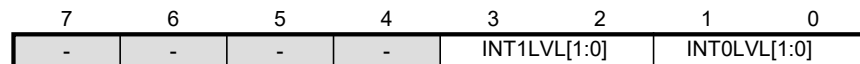
Figuur 16.13: Het interruptcontrolregister INTCTRL van de poorten. De bits 1 en 0 bepalen het interruptniveau van interrupt 0 en de bits 3 en 2 bepalen het interruptniveau van interrupt 1. Bit 4 tot en met 7 worden niet gebruikt.
